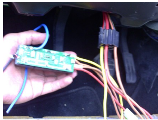
Figura no. 9 Conexión y alimentación de los Relevadores.
