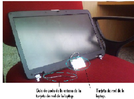
Fig. 7 Fotografía de la tarjeta de red y la guía de onda de una laptop
